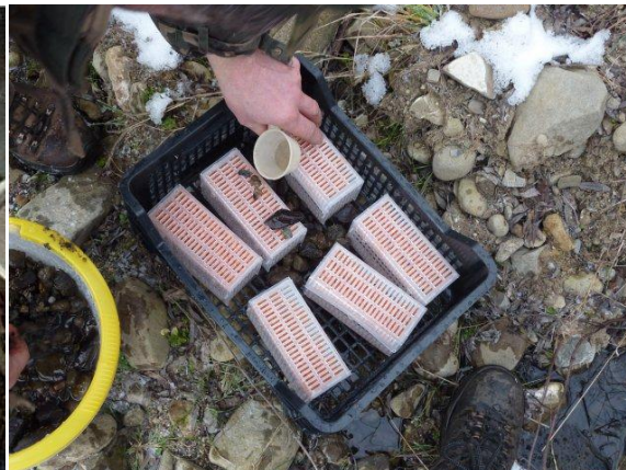
rozloženie WVB pred osadením do toku
